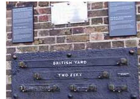
Öffentlich zugängliche Etalons verschiedener Länge an der Aussenwand des Royal Greenwich Observatory.
