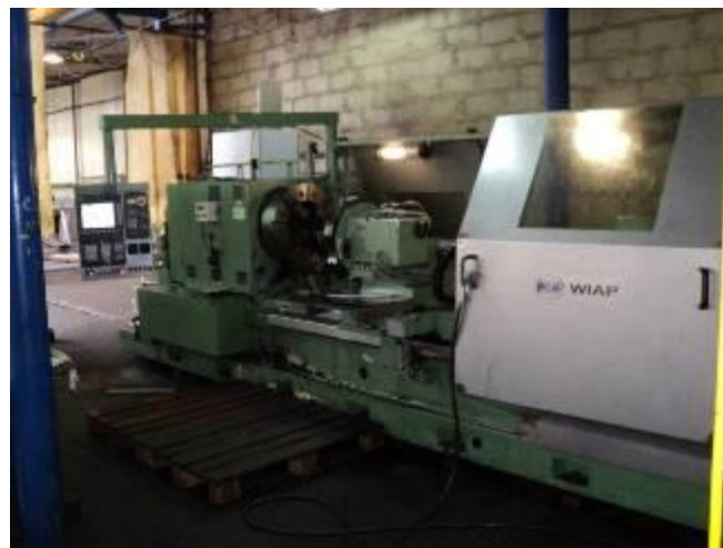
Bild 28: Das ist die Futji Seiki ex konventionelle Drehmaschine. Sie wurde 2007 bis 2010 in der Schweiz umgebaut. Es war nicht eilig, weil der Plan war, die Fabrikation umzuverlagern und dann die Maschine direkt an den neuen Ort zu stellen. Der Umzug hat sich aber bis heute verzögert.
