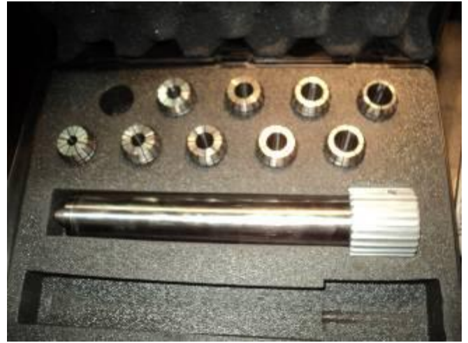
Bild 13: Hier die diversen Spannanzgen zum Bohrer einspannen. Diese Maschine kann bis 20 mm und für zylindrische Bohrerschäfte benützt werden.
