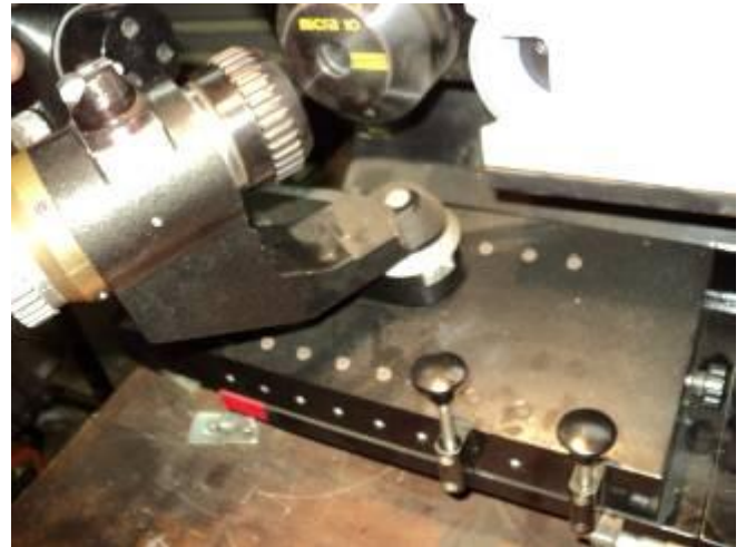
Bild 14. Hier wird der Bohrer eingespannt, damit er auf der Linie neben der Optik im Winkel horizontal steht und die 180 Grad Arretierung verriegelt ist. So können beide Seiten mit 10 Grad gleichmässig geschliefen werden.
