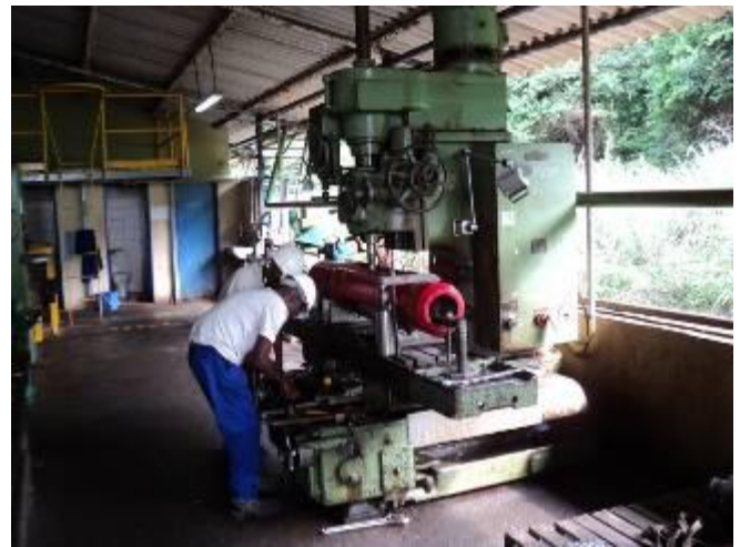
Bild 17: Es kam die Meldung, dass an der Hermann Fräsmaschine der Vorschub nicht mehr geht. Das Vorschubgetriebe musste geöffnet werden.
