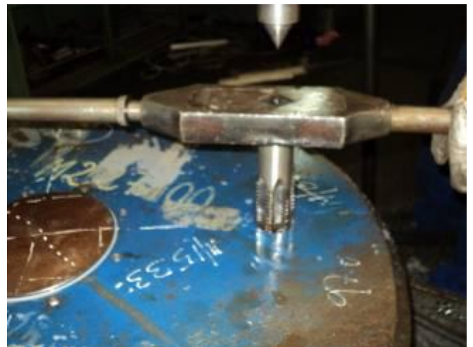
Bild 31: Jedes Mal, wenn die starken Männer am Windeisen drehen, wird von oben der Gewindebohrer geführt. Um das Windeisen neu anzusetzen muss die hydraulische Klemmung der Maschine wieder gelöst werden und neu nachfassen. Offensichtlich haben diese Leute die hier arbeiten, jahrzehnte lange Erfahrung; dies wird sofort bemerkt. Eigentlich eine Freude zuzusehen. Man sieht aber auch, dass viel Wissen aus Schweizer Lehrberufen und auch andern Ländern kommen. Was diese Leute heute wissen, ist nur zu bewundern.
