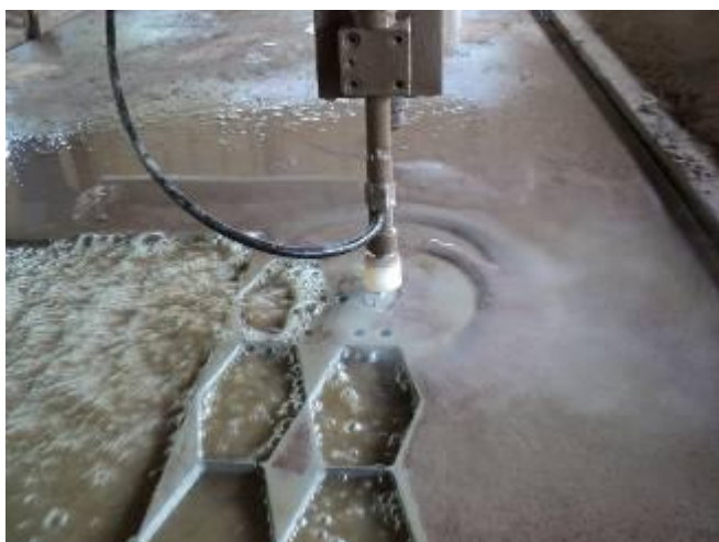
Bild 4: Innerhalb Minuten werden alle Konturen ausgeschnitten. Entgraten ist nicht nötig, die Kanten werden angerundet.
