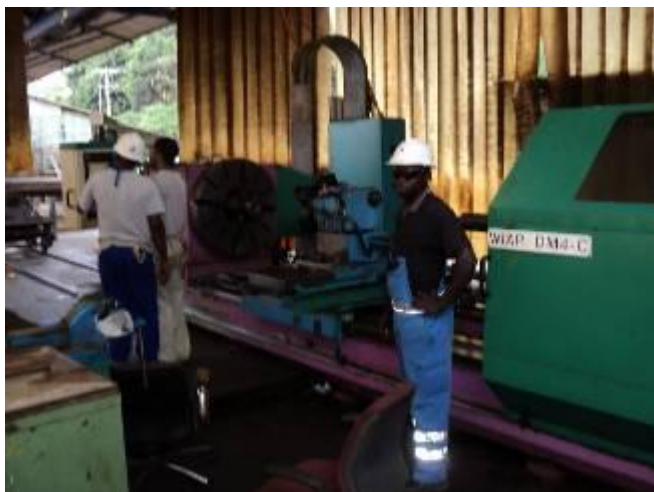
Bild 26: Diese Gurutspe Wiap DM4 C hat dasselbe Maschinenbett und den Kreuzschlitten wie die Gornati, nur eben der Spindelstock ist von einer Spanischen Maschine
