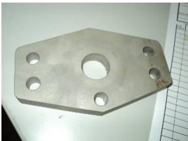
Bild 3: Als man 10 solche Flansche ausschneiden wollte, waren die Löcher unrund.
