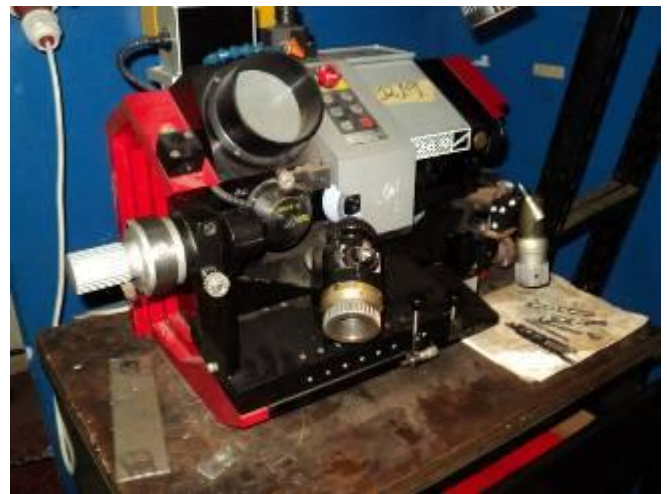
Bild10: Diese neue Bohrerschleifmaschine steht schon lange im Werkzeugzimmer. Als wir letztes mal einen Test machen wollten, haben noch die Bohreranahmen gefehlt, aber die hat man jetzt gefunden. Wir machen jetzt Testschleifen.
