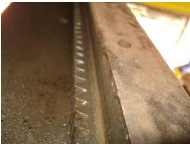
Bild 8: Hier sehen wir, wie die Zahnstangen und Führungen aussehen. Auch Rost und Sand verursachen den unruhigen Lauf.
