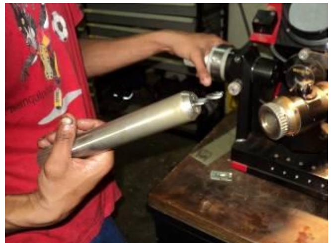
Bild 11: Der Bohrer wird in eine Spannzange gespannt, dann kann man mit 2 Winkel schleifen. Zuerst auf 10 Grad beide Seiten identisch, damit die Mitte stimmt, dann mit 30 Grad.
