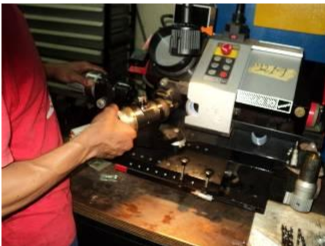
Bild 16: Carlo übt und schleift bis der Bohrer "ok" ist. Wir haben getestet, ob er gut bohrt und ob der Durchmesser stimmt, es ist gut. Jetzt werden Leute vom „Machining“, geschult. Wenn sie nicht genügend Arbeit haben, dann ist ein Mann da, der Bohrer nachschleifen kann.
