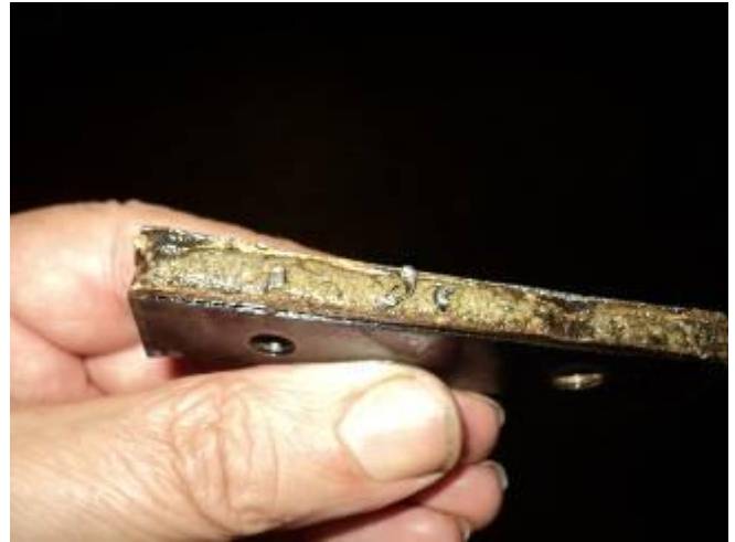
Bild 6: Die Abstreifen sehen gar nicht mehr so frisch aus. Neuer Gummi haben wir am Lager
