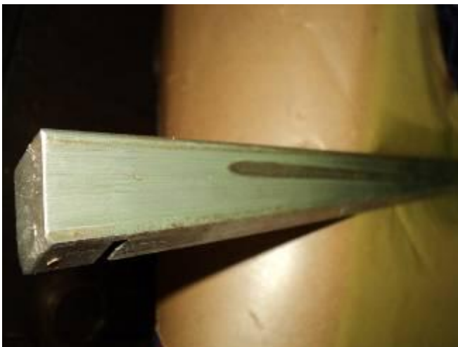
Bild 5: Keile raus nehmen und alles reinigen, vorbereiten, um beim nächsten Service zu schaben.
