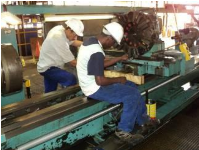
Bild 34, Bald ist es wieder soweit, um den Schlitten herunter auf die Führung zu lassen.
