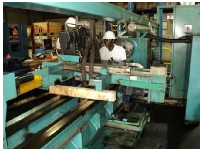
Bild 21: Jetzt sitzt der Schlitten auf Hölzern und ist bereit zum untersuchen, warum die Führungen diese Laufspuren haben.
