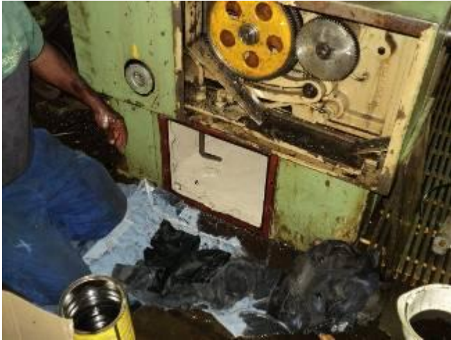
Bild 4: Ölwechsel an allen nächsten Maschinen. Und die Öltanks innen auch reinigen.
