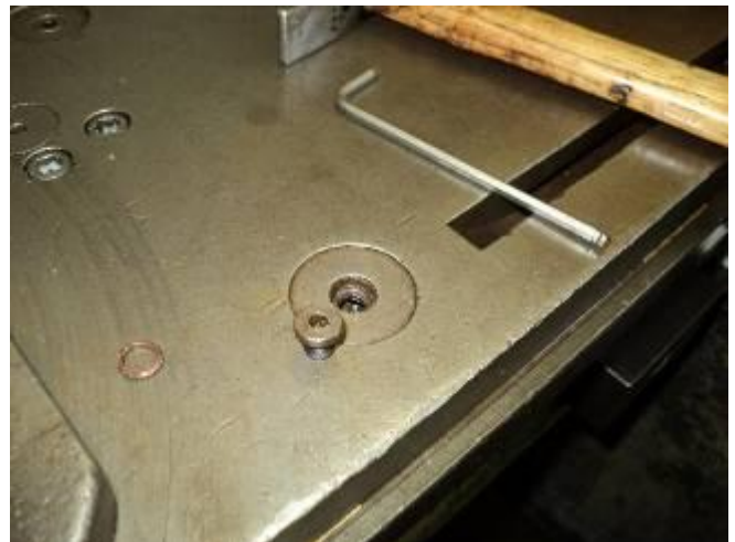
Bild 7: Dass unter den Schrauben vom X Schlitten Schmierstellen sind, wird in Zukunft mit roter Farbe markiert.
