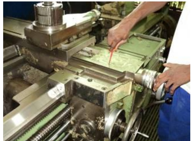
Bild2: Alles muss weg. Unter den Blechen verbirgt sich oft viel und nur ersichtlich ist, wenn die Abdeckungen wegschraubt werden.
