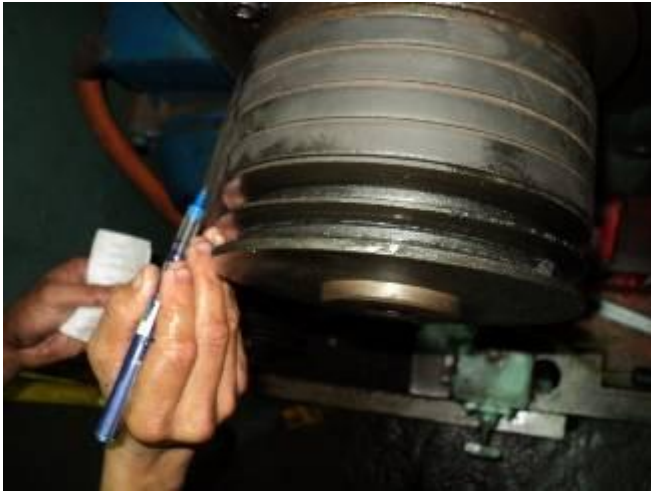
Bild18: Die Keilriemen des Spindelmotors sehen auch nicht mehr gut aus. Wir haben jetzt unsere Unterhaltsliste so erweitert, alle Maschinen alle Riemen mit Lagerort d.h Lagernummer erfasst. Was fehlt, wird bestellt. Die kosten ja nur ein paar Dollar. Aber wenn es nicht hier ist, kostet es viel, wenn man es mit DHL senden lassen muss. Unsere jungen Unterhaltsleute werden aber jetzt so angeregt, dass sie mindestens einfach von allen wichtigen Maschinen ein Satz Riemen an Lager haben.
