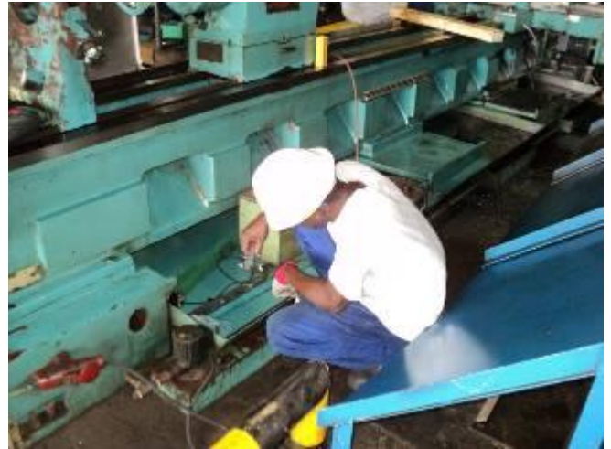
Bild 35. Hier hat Yoba gesehen, dass noch neue O Ringe montiert werden müssen. Yoba beim ausmessen.
