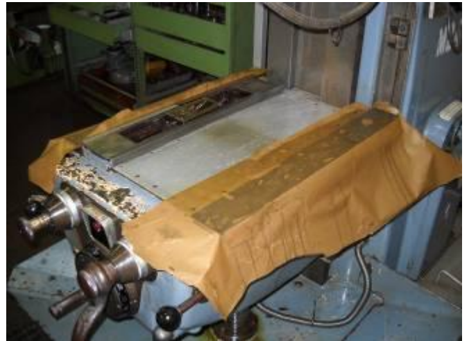
Bild 6: Bei Reparatur Arbeiten soll immer alles sofort mit Oelpapier abgedeckt werden
