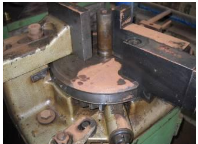
Bild 1: Corrosion an Werkzeugmaschinen
