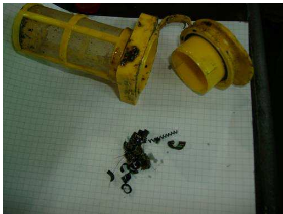
Bild 2: Bei allen Schmierungen wurden die Behälter entleert und gereinigt. Was da vor- gefunden wurde, war sehr erschreckend. Schmutz und anstelle Oel, Rostschutz in den Schmierbehältern. Wenn wir wüssten, wie lange schon? Der Rostschutz hat eine schlechte Gleiteigenschaft. Ungeachtet dessen sollte der präventive Unterhalt diese Behälter alle 2 Jahre einmal anschauen und innen reinigen. Wie oft mitten in der Produktion oft noch in der Nachtschicht ein Alarm, kein Oel. Und schnell ein Behälter und Oel auffüllen. War der Behälter aber sauber?
