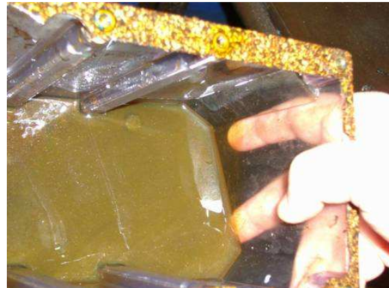
Bild 3: Der Rostschutz im Schmierbehälter anstelle Gleitbahnöl.
