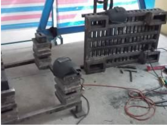
Photo 15: Der Rütteltisch nimmt langsam eine Form an.
