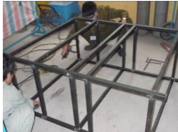
Photo 12: Eine Gruppe macht ein neues Gestell für unsere Metall Entspannungsanlage. Es soll ein transportfähiges Gestell sein, eingeräumt mit allem, was zur Anlage gehört. Der Lehrling, wo jetzt schweisst, hat es auch selber auf CAD gezeichnet.
