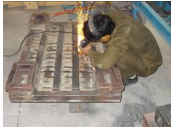
Photo 13: Hier schweisst ein B Lehrling ein neuer Vibrationstisch zusammen.
