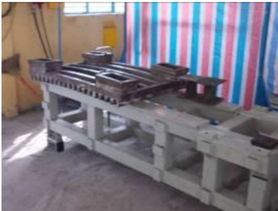
Photo 17: Dank dem, dass wir ein stabiles Maschinenbett der Wiap DM2 S in der Schule haben, konnten sie den Tisch ausspannen zum richten.
