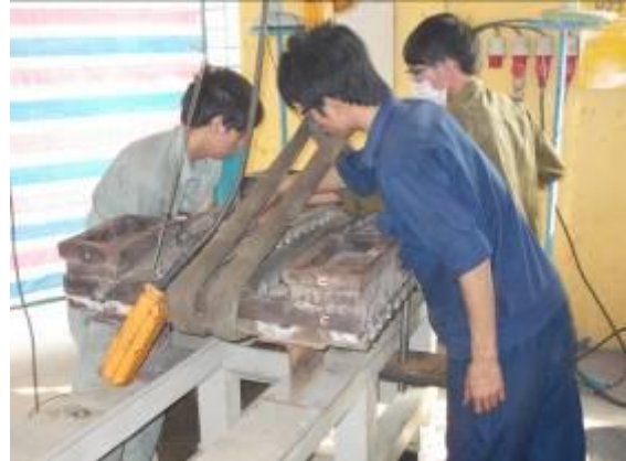
Photo 18: Sie spannen jetzt den Rütteltisch auf zum richten. Mehr darüber im nächsten Bericht. Ich glaube, wir müssen nie mehr einem Lehrling von uns erklären, warum ein Schweissplan gemacht wird!
