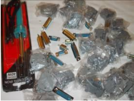
Photo 30: Für einen Kunden, der seine Fabrikation nach Ungarn verlegt, sollen wir einen Laptop mit nötigen Kabel, liefern. Wir entschieden, gleich 10 Kabel für die Sinumerik 810 T zu machen. Dazu benötigten wir die Stecker db 25 und db 9. Und die Instruktoren haben sie gefunden.
