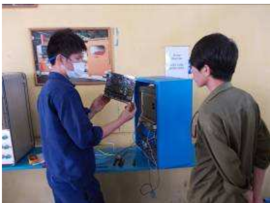
Photo 18: Unser Lehrling A 18, beim Ermitteln, was mit der CNC Steuerung Sinumerik 810T, los ist.
