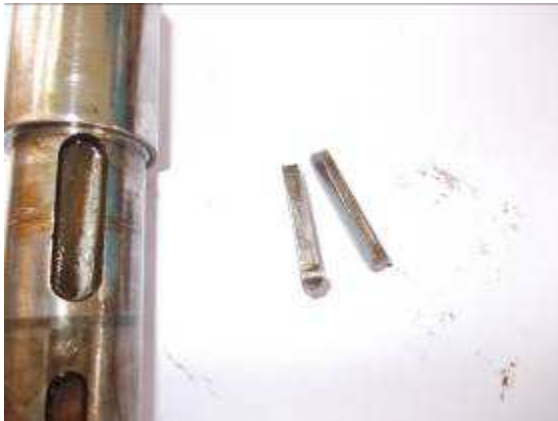
Photo 4: Erst nachdem fast alles demontiert war, konnten wir den abgescherten Keil finden.
