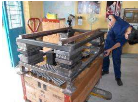
Photo 7: Hier bauen wir einen Vibrationstisch, der mit 8 Gummi Dämpfern ausgerüstet ist.
