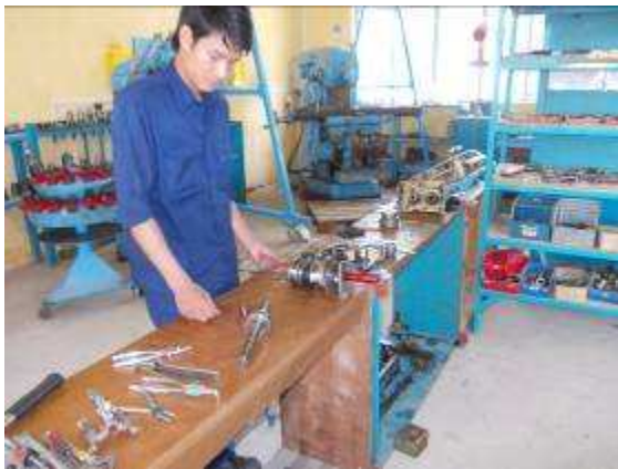
Photo 5: Beim Zerlegen ist wichtig, alles ordentlich hinzulegen für die Wiedermontage. Jeder Distanzring soll wieder am richtigen Ort montiert werden. A12 macht hier eine ganz gute Arbeit.
