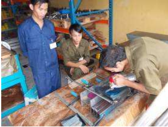
Photo 9: Für unsere erste CNC Drehmaschine, die wir in der Schule bauen, die WIAP DM2S, wird hier die Revolverkonsole geschabt.
