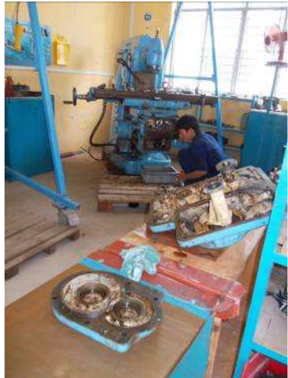
Photo 4: Das ganze Vorschubgetriebe wird zerlegt.
