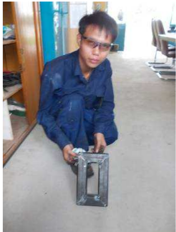
Photo 8: Für die Abschlussprüfung haben wir 16 solche 4-kant Rohrrahmen gemacht. Um zu sehen, ob die Lehrlinge innerhalb 1 mm schweissen können. 90 % war ok.
