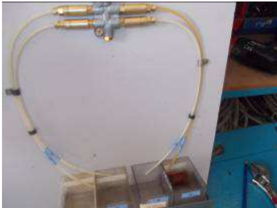
Photo 40: Damit die Lehrlinge verstehen, was eine Dossiereinheit 03 oder 06 oder 10 oder 16 ist, machten wir den Testplatz. Bei der 16-er Dossiereinheit kommt am meisten Öl pro Impuls. Bei der 03 nur ganz wenig.
