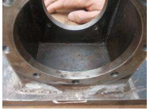
Photo 13: Das ist das neue Gehäuse der LC 5 Anlage. Leider nicht gut verputzt. Kantenbrüche 0,5 mm müssen wir noch viel intensiver üben.
