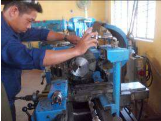
Photo 29: A19 Lehrling war bereits in der Armee. Er dreht hier einen Flansch auf der Schweizer Menziken Drehmaschine.
