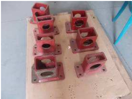
Photo 11: Die Gehäuse unserer Metallentspannungsanlage Wiap LC 20 und LC 50 sollten schon seit Monaten fertig sein. Den Guss kauften wir schon vor mehr als einem Jahr.
