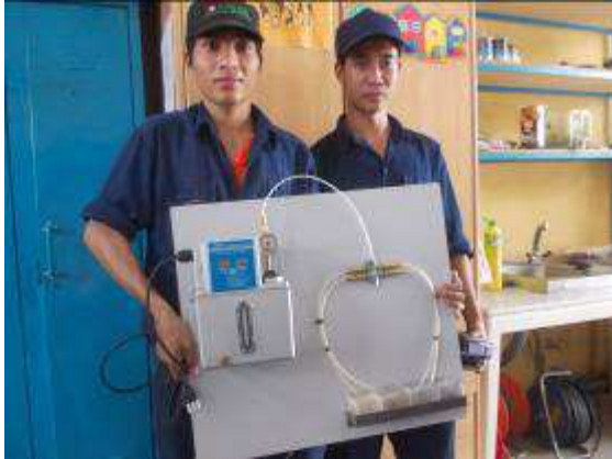
Photo 39: Der Lehrbetrieb muss weiter gehen. Damit unser Jungen auch etwas werden. Hier wird ein Testplatz gemacht für Impulsschmierung bei Werkzeugmaschinen.
