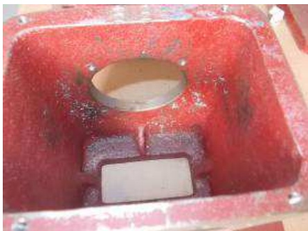
Photo 12: Dass, alles was bearbeitet wird, auch gereinigt werden muss, wissen unsere Lehrlinge noch nicht. Verschmutzung. Nicht richtig entgraten, ist auch hier noch nicht zufriedenstellen.
