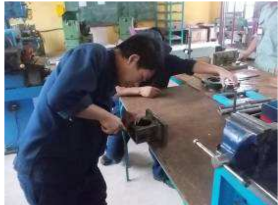
Photo 9: Der Lehrling A 24 beim entgraten des Gehäuses der Metallentspannungsanlage Wiap LC 05. Mit dem Entgraten haben wir in Vietnam noch etwas Mühe. Die Lehrlinge und die Lehrer sehen den Sinn nicht so ganz ein, für was das ist.
