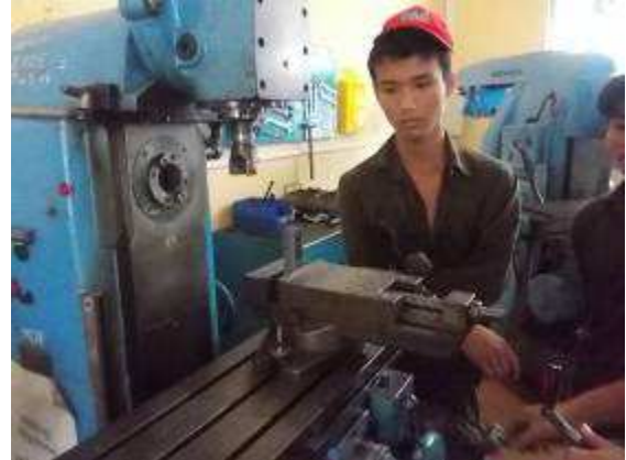
Photo 43: Der Lehrer, welcher die Lehrlinge hier betreut, gibt zu wenig klare Anweisungen. Diese Ausladung fräsen mit Hartmetall, dann noch quer fahren - Stopp! Wir sollten mehr Zeit verfügbar haben, um bessere Details schulen zu können. Die Theorie gehört eben auch dazu.
