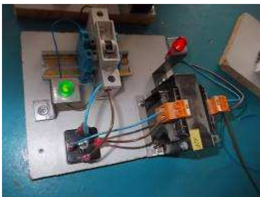
Photo 39: Da wir aus aus der Schweiz einige kleine Transformatoren 230 Volt, 24 Volt haben und auf dem Markt so ein Gleichrichter für 1 Franken zu kaufen war.
