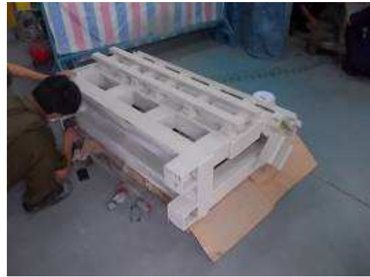
Photo 15: Das neue Maschinenbett der kleinen CNC Drehmaschine Wiap dm2_w
