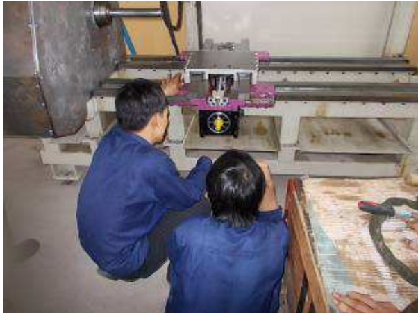
Photo 27: Der X Motor fertig angebaut.
