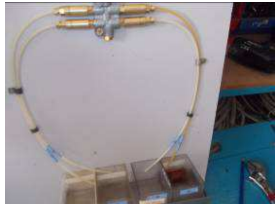
Photo 36: Damit die Lehrlinge verstehen, was eine Dossiereinheit 03 oder 06 oder 10 oder 16 ist, machten wir den Testplatz. Bei der 16-er Dossiereinheit kommt am meisten Öl pro Impuls. Bei der 03 nur ganz wenig.
