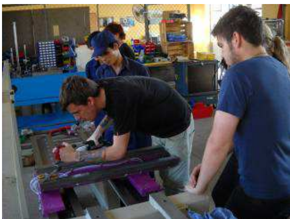
Photo 23: Jim zeigt das Schaben. Die Führungen waren oben verrostet von der Fracht.
