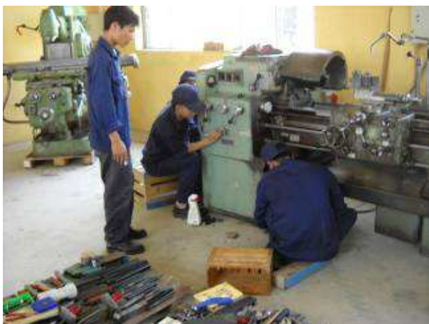
Photo 6: Vorher: Im Raum 2a wird die Menziken Drehbank hergerichtet. Reinigen, schleifen,
