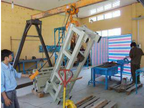
Foto 21: Jetzt heben wir das Maschinenbett der DM2 S hoch. Wir müssen eine Lösung zum Füllen haben. Das Füllstoff Konzept haben wir etwas geändert mit dem Losfüllstoff. Es gibt noch 2 Stück 800 mm Kranerhöhungen.
