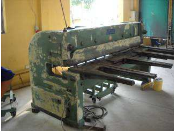
Photo 5: Vorher: Schlagschere Hänggi. Schweizer Maschine - hatte viele Farbschäden. Sie wird neu gespachtelt und dann auch gespritzt.
