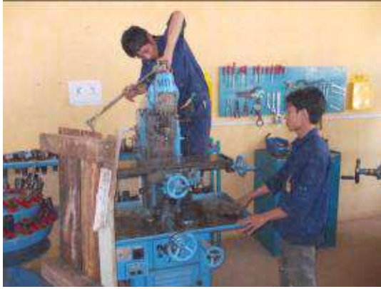
Photo 43: Lehrling Hieu (A9), suchte die Schmierstellen und hat diese auch geschmiert. Alle Oel Schmierstellen werden mit rot gekennzeichnet. Alle Fett Schmierstellen gelb. Für alle Maschinen werden noch die Kurzanleitung erstellt mit Photo der wichtigsten Handhabung. Auch der Schmierplan pro Maschine wird noch erstellt und der Oelwechsel- und Verschleisswechselplan. Und alles ist in der gelben Box.
