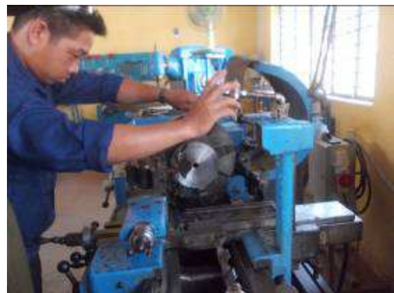
Photo 7: A19 Lehrling war bereits in der Armee. Er dreht hier einen Flansch auf der Schweizer Menziken Drehmaschine. Jan 2013.
