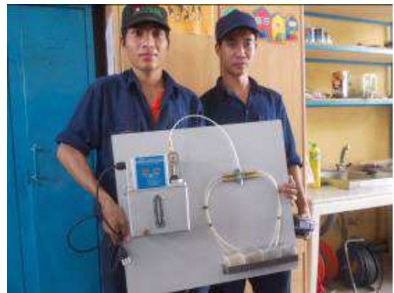
Photo 35: Hier wird ein Testplatz gemacht für Impulsschmierung bei Werkzeugmaschinen.
