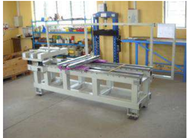
Photo 24: Das ist unsere Wiap DM2S Horizontal CNC Drehmaschine im Aufbau.
