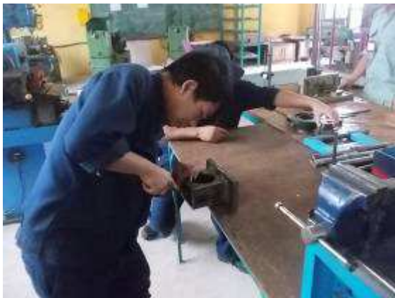
Photo 11: Der Lehrling A 24 beim Entgraten des Gehäuses der Metallentspannungsanlage Wiap LC
