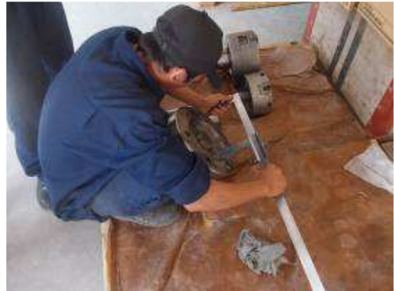
Photo 12: Die intensiven Test's XY200 und XY201 machten wir mit den A Lehrlingen. Die Test's nahmen wir mit in die Schweiz zum auswerten. Hier wird gemessen, wie eine ASA Spindel Nase gemessen werden kann.
