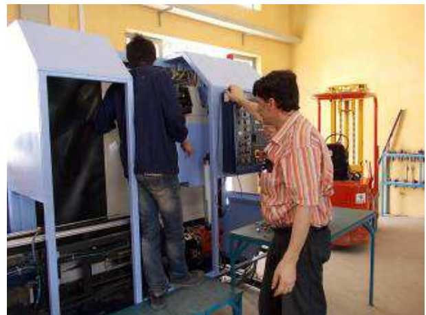
Photo 8e: An der Vertikal Drehmaschine Wiap DM2V wird jetzt alles schön durch nummeriert. Elektroschema wird neu gemacht.
