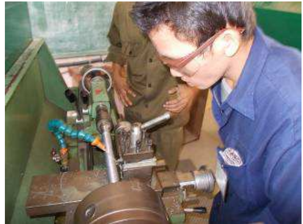
Photo 18: 220 mm lange Trapezspindeln, 26 x 4, selbst hergestellt.
