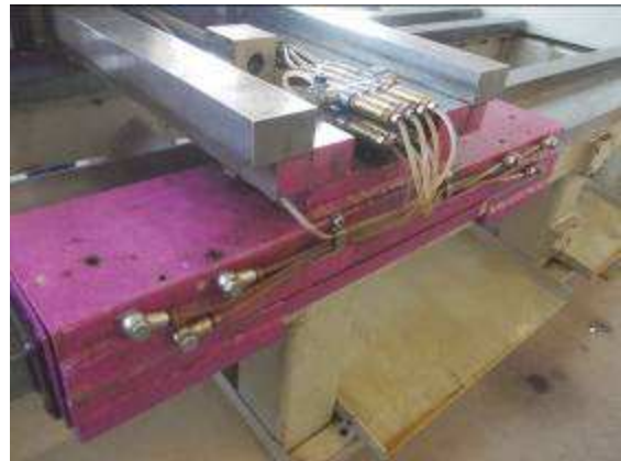
Photo 31: Das ist der Längsschlitten der DM2_S. Die Schmierstellen müssen noch alle abgedeckt werden. Wir müssen künftig eine kluge Lösung ausdenken, damit die Oeleintrittstellen besser, einfacher und kostenbewusster abgedeckt werden können.
