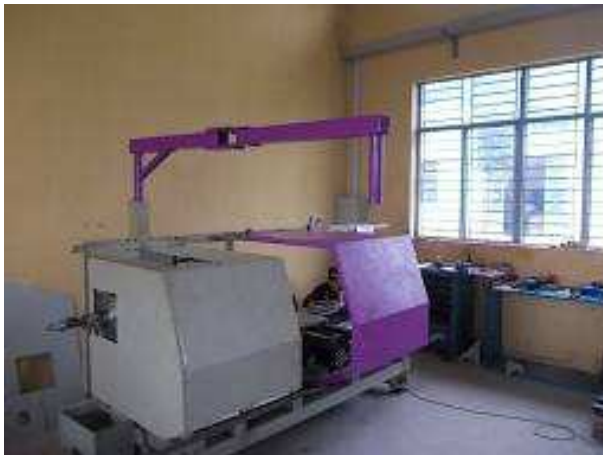
Photo 33: Unsere erste CNC Drehmaschine Wiap DM2S aus Vietnam. Wir sind nicht zufrieden mit der Qualität. Diese Maschine wird nur in der Schule als Montage Test Maschine dienen. Auch durch den Rost, die Luft, keine Klimaanlage, ist gut zu prüfen wie kann Maschinenbau in Vietnam gemacht werden?
