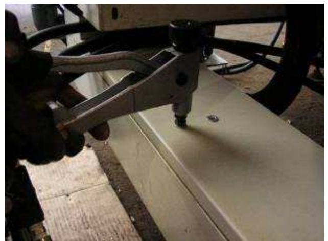
Photo 9: Jetzt steckt man das Tuptara ins vorgebohrte Loch, z.B für M6 = 7 mm, dann drückt man die Zange fest zu. Die Blindmutter deformiert sich und verbindet sich fest mit dem Blech.
