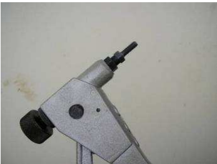
Photo 7: Vorne sieht man in dem Fall die M6 Schraube die heraus guckt und da schaut man Tuptara drauf, das heisst diese Blind Nietmutter.
