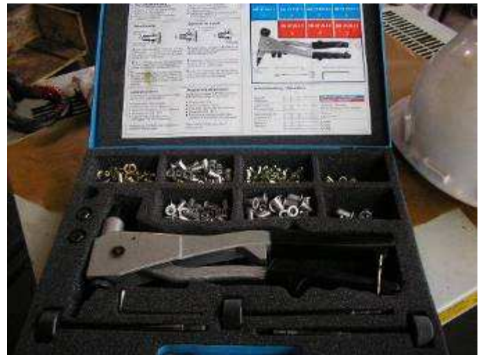
Photo 3: Hier ist in der Box eine Zange mit Einsätzen aus Aluminium oder aus Stahl. Je nach Grösse
