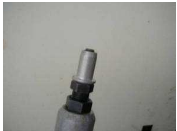
Photo 8: So ist es bereit, um die Blindnietmutter in das vorgebohrte Loch zu stecken.
