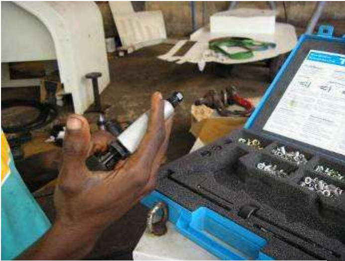
Photo 6: Nachfolgend machen wir eine Demonstration, wie man Tuptara anwendet, man nimmt die Zange und setzt die Zugschraube ein die das Gewinde. Je nach der Tuptara Grösse die eingesetzt werden soll.
