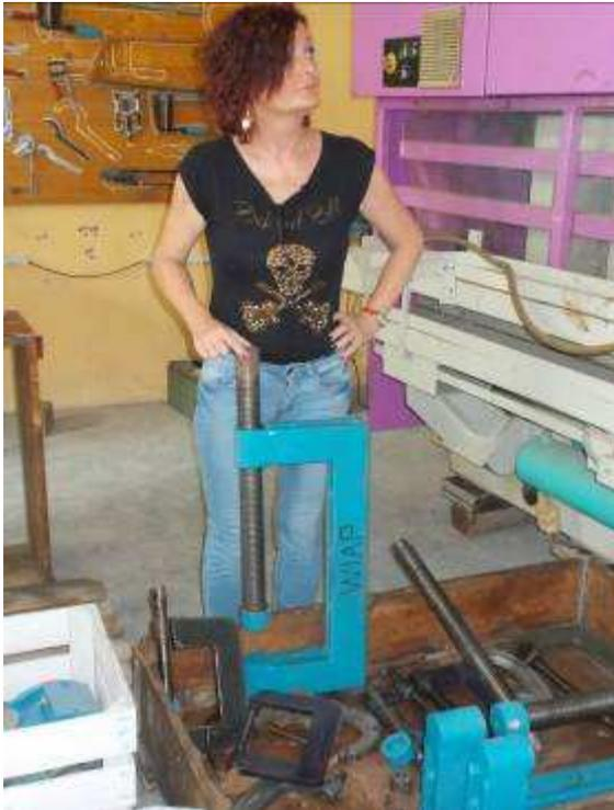
P12: Die grossen schweren Schraubzwingen spannen 400 mm.
