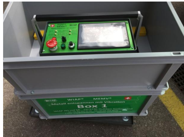
WIAP MEMV E Steuergerät in Transport Box
