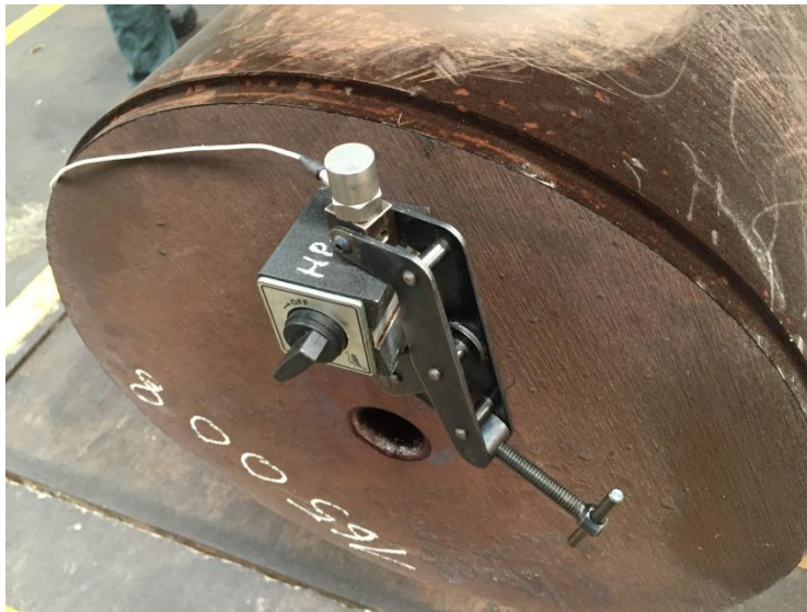
Photo : Die Messsonde wie sie am Werkstück angebracht wird mit Magnet Bitte immer Achsrichtung der Erregung beachten .Beim 2 D Vibrieren ist immer eine Achse unangetastet d.h. die Sonde soll die Achsrichtung prüfen, welche angetastet wird.
