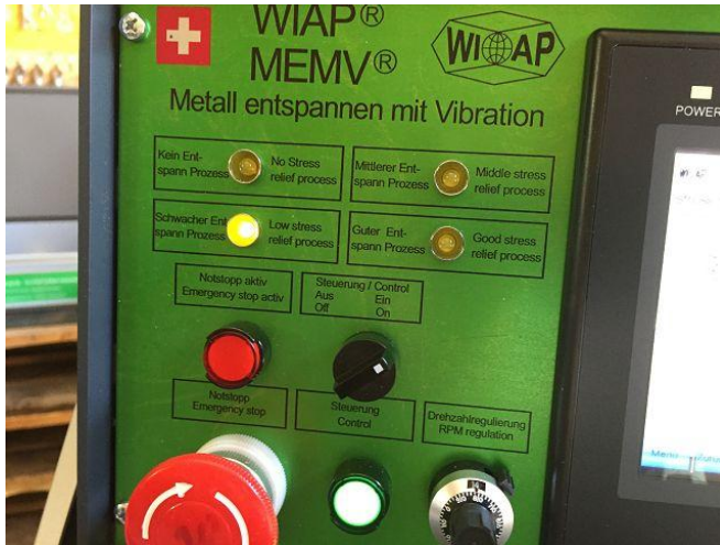
Steuer Gerät mit Status Anzeige vom MEMV_E
