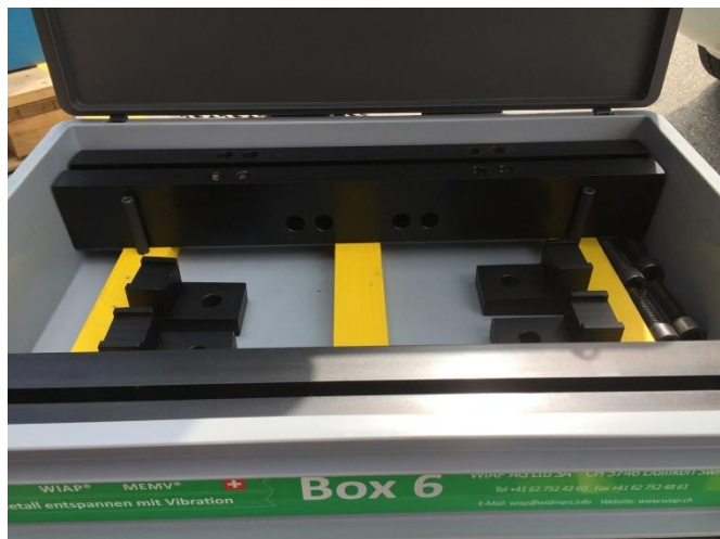
Aufspannvorrichtung Wellen Durchmesser 60 bis 420
