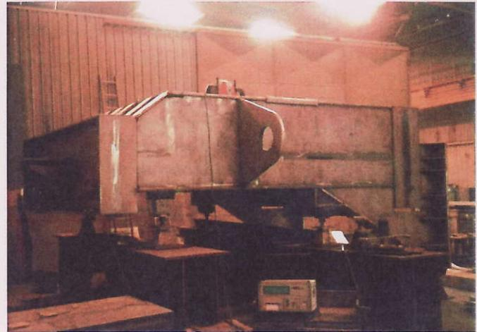
Abb. 12: Entspannen einer Maschinengrundkonstruktion 4,5t
