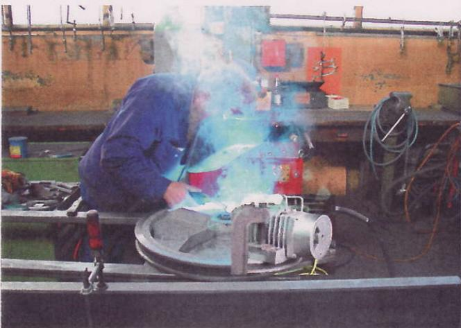
Abb. 9: Schweißen während dem die für die fortlaufende Relaxierung des Bauteils errechnete Schwingungsenergie anliegt
