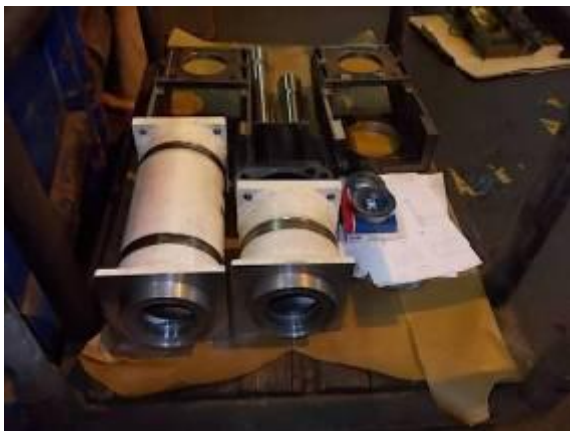
Bild 3) Der Vorschubmotor wurde mit einer Verlängerung nachgebildet und eine Untersetzung von 1:3 gemacht.
