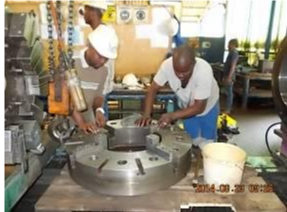
Bild 29) Das Futter wurde demontiert, gereinigt und die Verletzungen abgezogen. Die defekte Spindel provisorisch repariert bis eine neue Spindel da ist.
