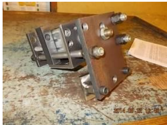
Bild 6) Das ist die Bremskonstruktion. Diese war am alten Motor im Motor. Wir haben jetzt an allen CNC Maschinen denselben Motor. Daher wollten wir keinen Motor mit Bremse bestellen.
