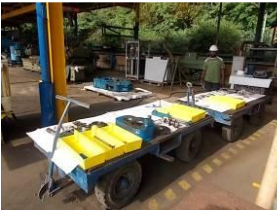
Bild 65) Ordnung und sauberes Zerlegen hilft, dass keine Montage Fehler passieren.
