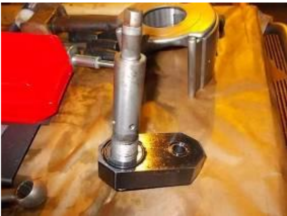
Bild 37) Das ist die Schmierpumpe, welche nicht mehr schmierte . Mit einem Excenter wird diese angetrieben, wenn im Eilgang in der Z-Achse gefahren wird.
