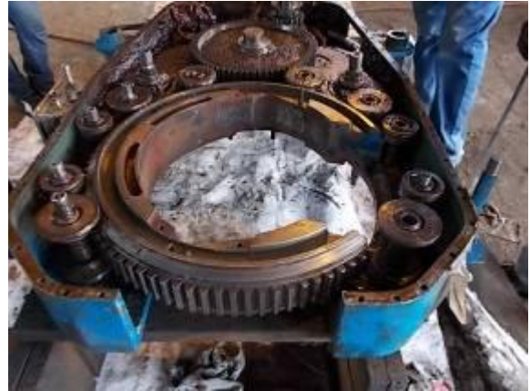
Bild 66) Das Getriebe sieht innen sehr schmutzig aus.
