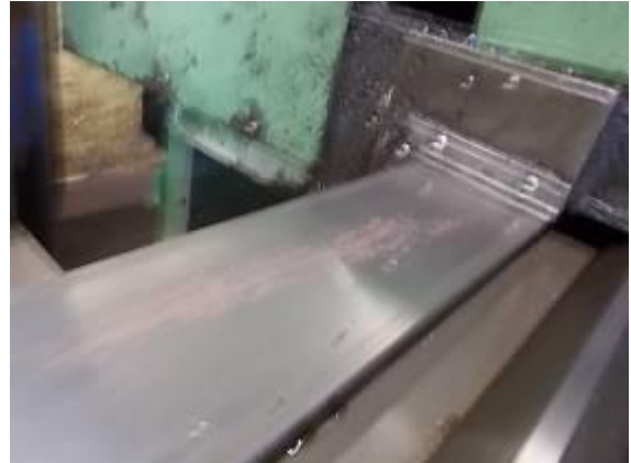
Bild 74) Nur wenige Tage Maschinenstillstand und schon ist der Rost da.
