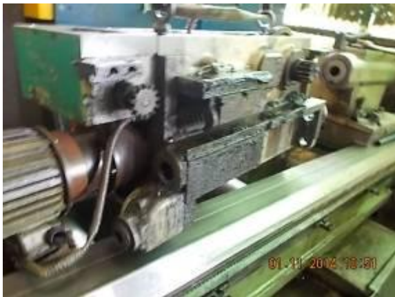
Bild 49) An der Niles Drehmaschine hat es jetzt 3 mal einen Stift abgerissen. Einmal den Axiallagerbock abgedrückt und zerrissen.
