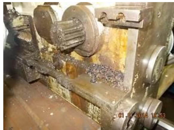
Bild 51) Es wurde der Kreuzschlitten demontiert um den Fehler zu sehen.
