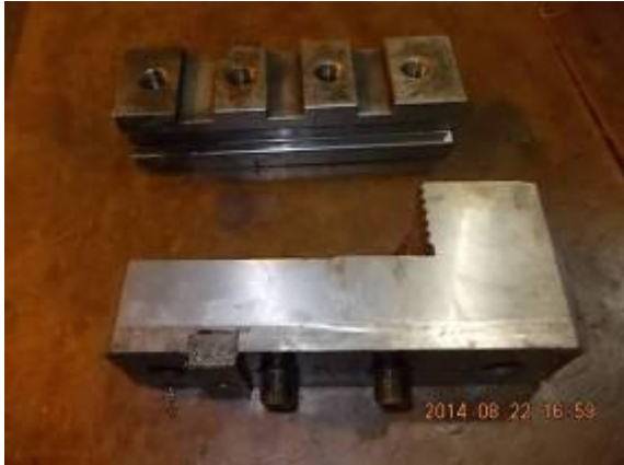
Bild 26) Die Backe hat es abgekippt, weil sie zu weit draussen war.
