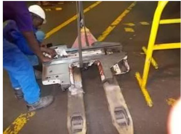
Bild 43) Der Kreuzschlitten wird nach der gründlichen Reinigung wieder für die Montage vorbereitet.
