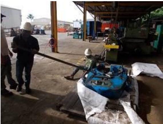
Bild 64) Mit grossen Verlängerungen musste ein Teil der Schrauben geöffnet werden.
