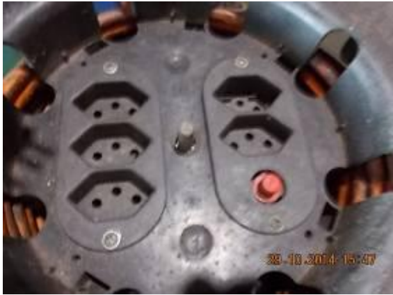
Bild 48b) Schweizer Kabelrollen für 10 Amp. nicht 16!
