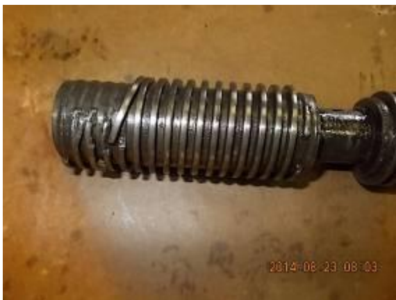
Bild 27) An der Spindel das Gewinde abgedrückt.
