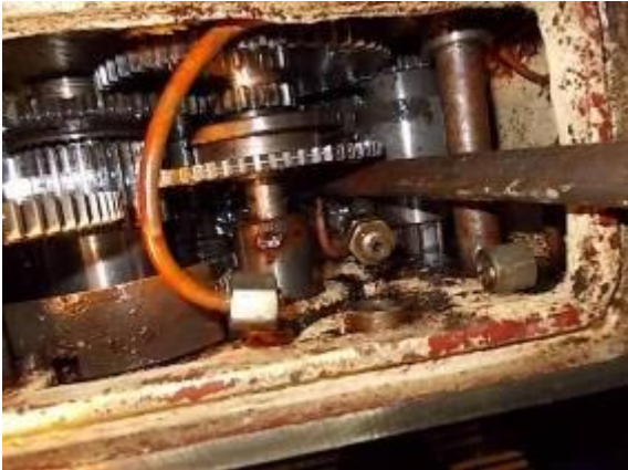
Bild 40) Das Getriebe hatte viel Schlamm und Schmutz unten drin. Es ist unmöglich, dies ohne Demontage, je einmal reinigen zu können.
