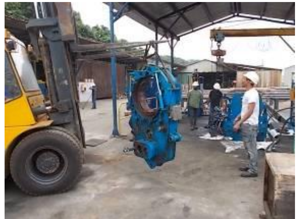
Bild 61) Das Innenelement wird ausgebaut zum zerlegen.
