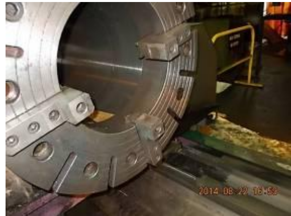
Bild 24) Hier habe die Operateure bei der Wiap Gornati diese sehr guten Spannbacken, der 4 jahre alten Planscheibe so weit hinaus gespannt, dass bei den Backenspindeln die Gewindegänge ausgebrochen sind. Nur weil sie zu faul waren, die Oberbacke nach vorne zu schieben. Es wird deutlich, dass die bis ins 2009 gemachte Schulung, fehlt. Das Denken muss weiter gelernt werden.
