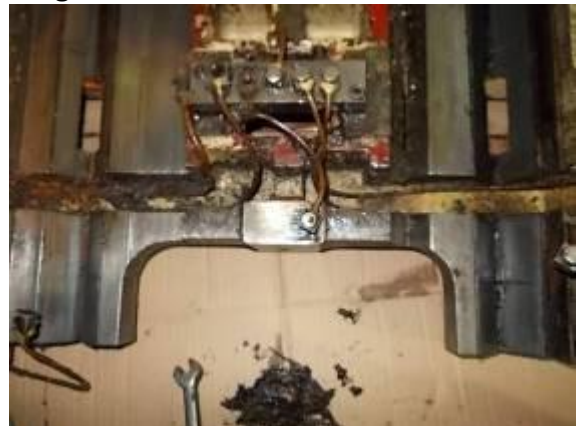
Bild 39) Der Kreuzschlitten unten, viel Schmutz.
