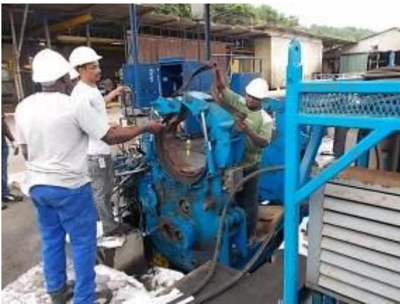
Bild 58b) Wie es ist im Unterhalt, am Samstag, den 29.11.2014, um 16:00, kam die Meldung, dass bei der Farr Maschine das Getriebe blockierte.
