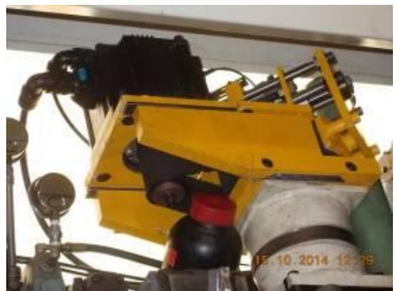
Bild 15) Der neu angebaute X Spindel Vorschubantrieb.
