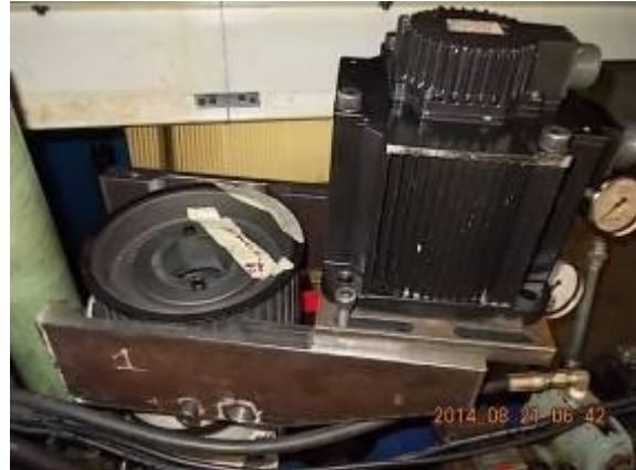
Bild 5) Der X Motor 1/3 untersetzt mit 3 kW. Der alte Motor hatte 7 kW und war 1:1. Jedoch nur 10 M Eilgang mit einer 10-er Kugelrollspindel.
