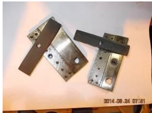
Bild 44) Wieder, aufgrund der V Führung, wird der Untergriff, der noch nicht so alten Maschine TUR, so belastet, dass es die Gleitbeläge durch die Querkräfte und dann das intensive nach oben drücken, abgerissen hat. Wir mussten die Klebefläche neu aufrauen, damit es Hohlräume für den Klebstoff hat. Danach neu Kleben. Mit Messing Senkschrauben gegen das erneute Abreißen der Gleitbeläge geschützt.
