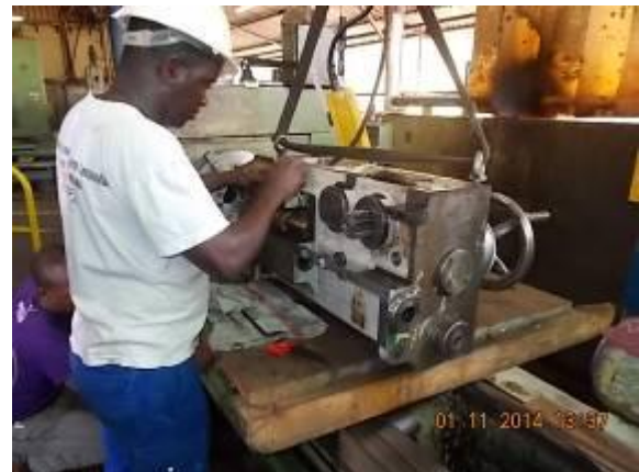
Bild 52) Das Vorschubgetriebe vom Kreuzschlitten wurde zerlegt und die Klemmstelle ausfindig gemacht. Ein Teil der Mutter, die über die Trapezspindel ist, ist nicht aus dem Gewinde heraus
