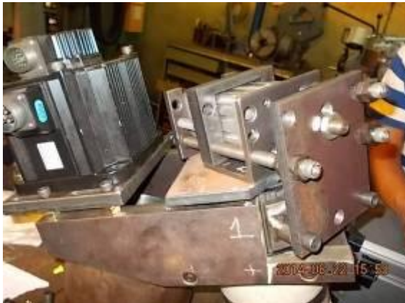
Bild 8) Das ist jetzt die Riemen Bremse mit dem 63-Zylinder. Er drückt mit 6 Bar, 164 kg.
