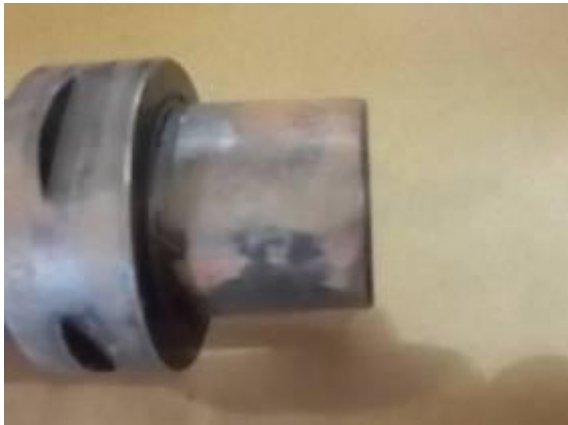
Bild 23) Das ist eine Sandvik Capto 63 Werkzeugaufnahme. Die kostet ein paar Dollar. Liegt im freien und verrostet. Kein Rostschutz.
