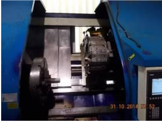
Bild 16) Die Mega Bore CNC Drehmaschine. Neu mit der Sinumerik 802Dsl CNC Steuerung.
