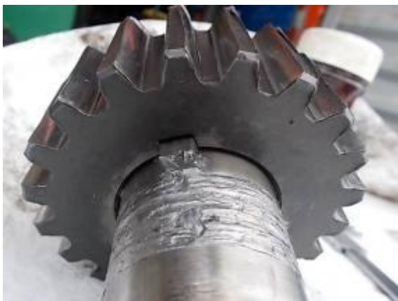
Bild 70) Das grosse Zahnrad: Auf der Welle hat es die Keile abgeschert.
