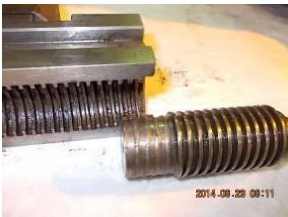
Bild 28) Viel zu weit haben sie die Oberbacke herausgedreht.
