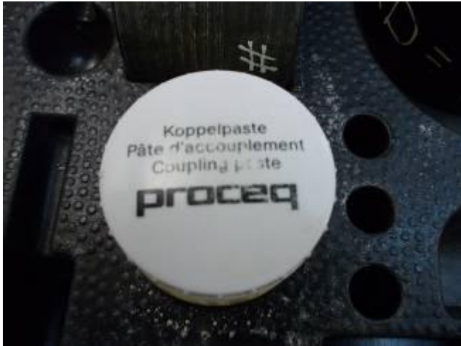
Bild 6: Diese Koppelpaste ist auch in der Messgerät Verpackung. Diese wird benötigt, wenn das Werkstück leicht ist.
