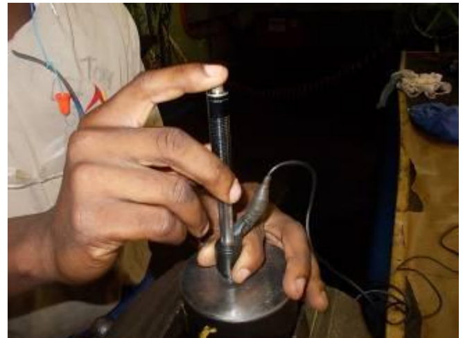
Bild 15: Jetzt drückt man oben auf den Auslöseknopf bis aus dem Innern ein leises Geräusch kommt. Das bedeutet, das Schlaggerät hat die Aufgabe erfüllt und die Anzeige am Gerät zeigt den Wert an.
