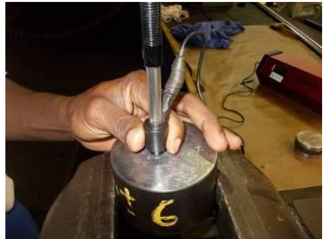
Bild 14: Dann setzt man das Schlaggerät auf das Werkstück resp. Prüfstück, drückt es gut nach unten, damit es nicht federn kann.
