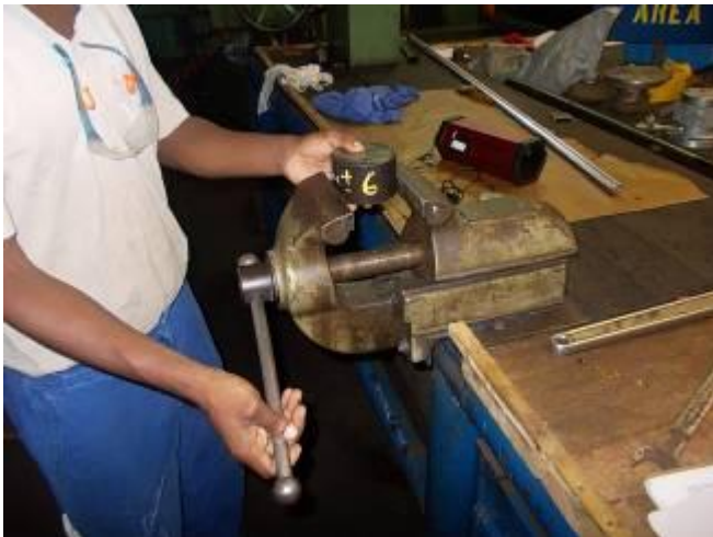
Bild 7: Von Vorteil ist, wenn die Prüfplatte gut gehalten wird, damit diese nicht nachfedert. Sonst gibt es unterschiedliche Messresultate. Wir hatten 0.005 % Abweichung.
