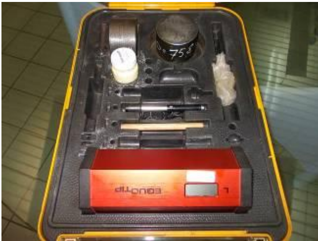
Bild 17: Alles wieder sorgfältig wegräumen. Das Schlaggerät Kabel soll nach unten zeigen, damit der Stecker nicht beschädigt wird, wenn die Box geschlossen wird.
