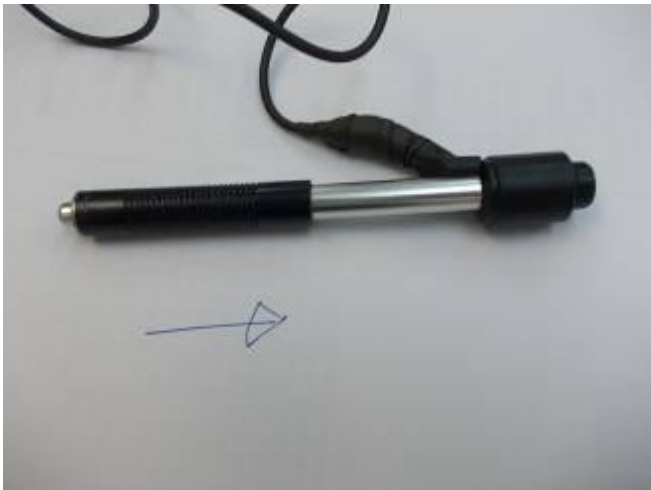
Bild 12: Dann kann eine Ladebewegung gemacht werden. Der schwarze Kunststoff wird ca. 30 mm nach rechts geschoben.
