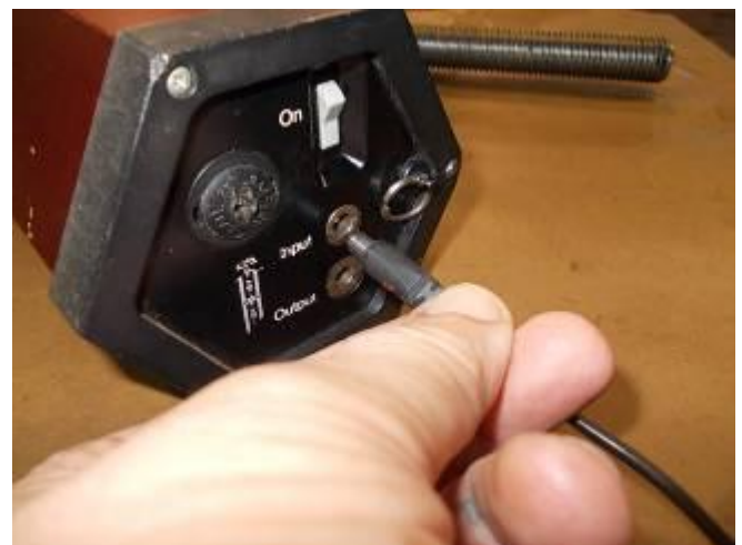
Bild 10: Das Schlaggerät wird hier am Stecker Input angeschlossen
