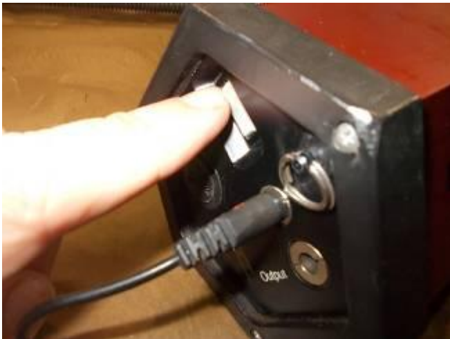
Bild 11: Danach wird der Schalter auf ON gestellt und man soll minimum 5 Sekunden warten.
