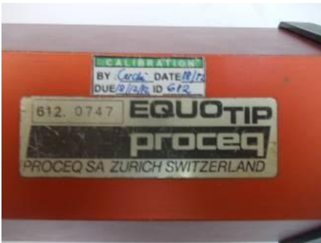
Photo 18: Das Gerät wurde am 18.06.2012 von uns kalibriert. Es wird ab nun alle 6 Monate kalibriert. Autorisiert für das Kalibrieren ist der Maschinenunterhalt.
