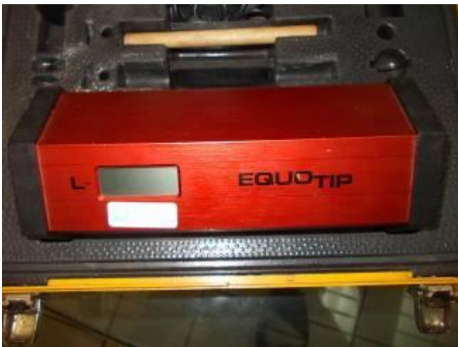
Bild 3: Das Gerät zeigt einen L Wert an.
