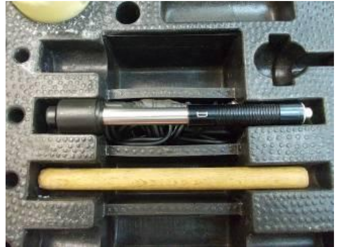
Bild 8: Das Mittlere ist das Schlaggerät. In unserem Fall der Typ D.
