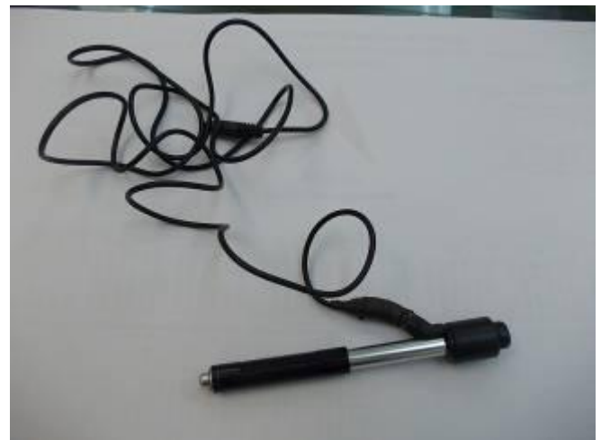
Bild 9: Schlaggerät Typ D. Vorsicht beim Geräte wegräumen. Den seitlichen Stecker nach unten verpacken.
