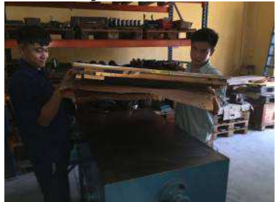
P43 Auch eine grosse Touchier Platte, welche 1,4 Tonnen schwer ist, haben wir im Lehrbetrieb.
