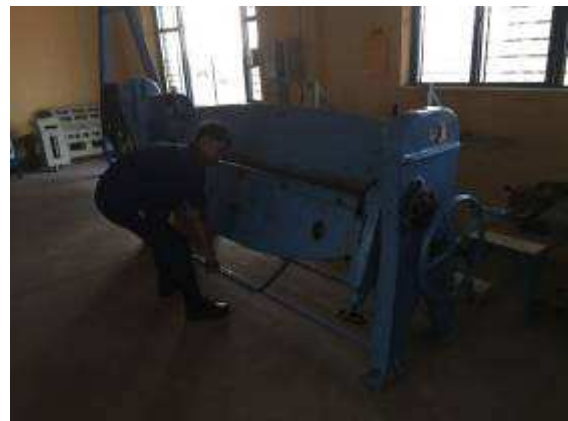
P14 Blechabteilung , Manuelle Abkantmaschinen Asti. 2000 x 2mm kann abgekantet werden.
