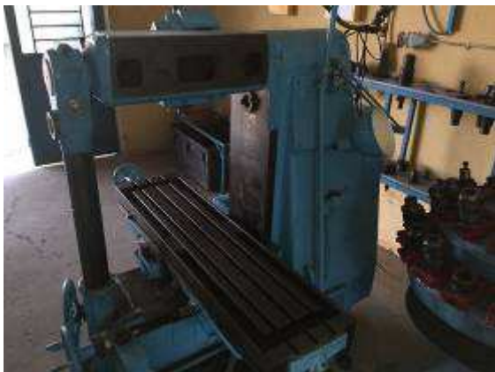
P8 Starrag Rorschach Fräsmaschine ideal um 45° Kanten zu fräsen über die ganze Länge
