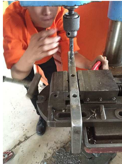
P5 Lehrling bohrt 3 x M16 in die Schraubzwingen
