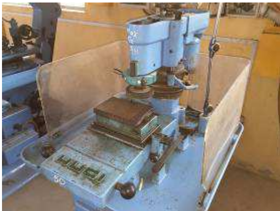
P29 Flach Topf Schleifmaschine Hugi aus dem Raum Solothurn, Schweizer Maschine um Unterlagen und Distanzen zu schleifen.
