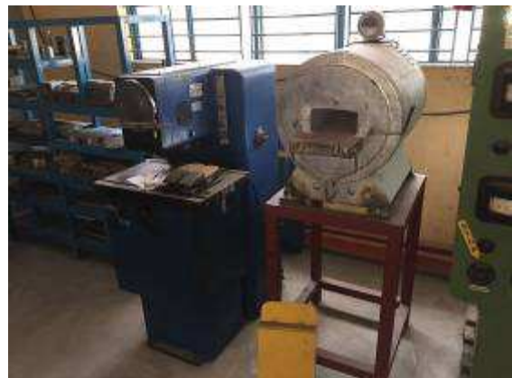
P37 Doch auch noch ein kleiner Härte Ofen der nur mit 220 Volt läuft haben wir noch im Lehrbetrieb und ein Härteprüfgerät von der Firma Flükiger in Oberdorf.
