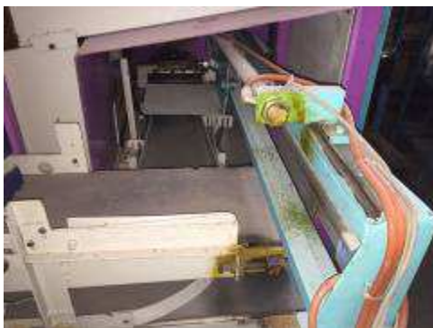
P47. Diese Maschine arbeitet Mannarm. Vollautomatisch, ohne Operateur. Es muss nur alle ca. 30 Minuten die fertigen Teile weg genommen werden und wieder neu eingelegt werden. Ideal Maschine um die Lehrlinge die Automation zu schulen.
