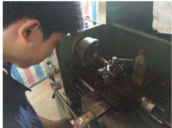
P10- Lehrling beim drehen, Brille vergessen! Das ist ein grosses Problem immer wieder müssen die Jungen auf die Gefahr hingewiesen werden. Wir werden jetzt dann denen die keine Brille tragen immer 10000 Dong = 0.5 Fr. Abzug vom Motivations Geld machen.
