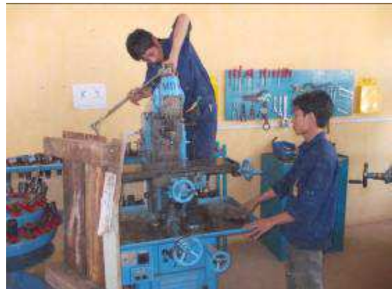
Photo 24: Hier der Lehrling Hieu, welcher die Schmierstellen suchte und auch schmieren musste. Alle Oel Schmierstellen werden noch mit rot gekennzeichnet. Alle Fett Schmierstellen mit gelb. Für alle Maschinen werden noch die Kurzanleitung erstellt mit Photo der wichtigsten Handhabung. Auch der Schmierplan pro Maschine wird noch erstellt und der Oelwechsel- und Verschleisswechselplan. Und alles ist in der gelben Box.
