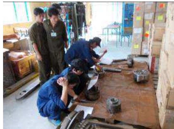
Photo 18: An dem Posten sollen die Lehrlinge aufschreiben, welche Spindelnasengrösse die da liegenden Spindeln haben, ASA 5? ASA 15? Lange studierten sie die Zeichnungen.
