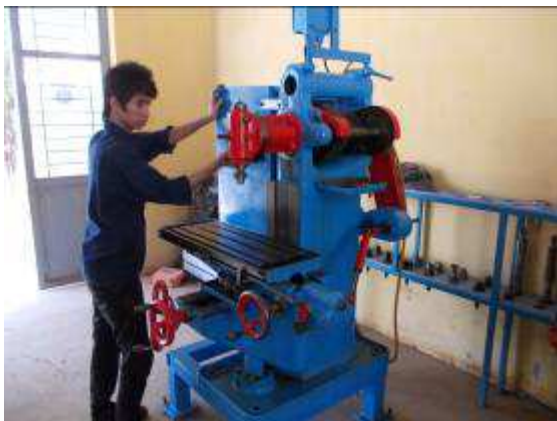
Photo 22: Das Wartungssystem hat 3 verschiedene Arbeitsaufträge. 1. Visual Control, 2. Inspektion, und 3. Geometrie Kontrolle. Die „Visual Control“ ist alle Monate. Inspektion 2x pro Jahr. Geometrie 1 x pro Jahr.
