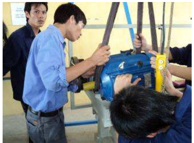
Photo 12: nun auch der 5,5 KW Motor noch vorbereiten für den Spindeltrieb
