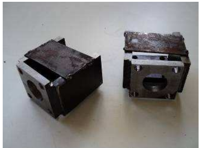
Photo 7: Ja da hat der Lehrer Chef, um eine Nacharbeit zu machen, dem Lehrling gesagt, dass man das Werkstück besser aufspannen kann, schweisse da schnell Bleche ran! Jetzt habe ich es verboten, man darf an keinem fertig bearbeiteten Werkstück mehr etwas anschweißen wenn es eine wichtige Funktion hat, wegen dem Verzug! Das hat man dann ganz schell wieder abgetrennt und tat so, als wäre nichts passiert!
