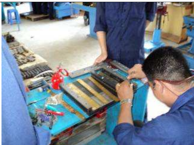
Photo 19: An der neuen Maschine Wiap DM2S montieren wir jetzt anstelle Kunststoffbeläge, Messing. Weil wir hier in Vietnam viel Staub und Sand haben, testen wir das an unserer eigenen Maschine, die wir für uns selber bauen. Zudem haben wir bei den Unterhaltsarbeiten in Angola gesehen (wo Maschinen sind die Jahrgang 1950 haben), was seit Jahrzehnten läuft und nicht ersetzt werden musste, darum werden wir eine gemischte Lösung testen zwischen neuem und altem Maschinenbau. Und hier in Vietnam darf ja noch etwas Handarbeit gemacht werden; die Kosten sind ja etwas tiefer und sie sind geschickt und haben grosse Freude, an so gewissenhafter Arbeit.
