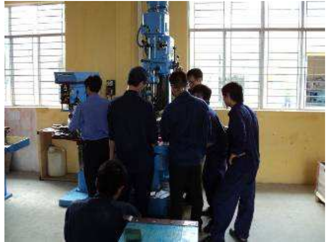
Photo 17: Zum Glück haben wir die alte Schweizer Reibo Bohrmaschine mitgenommen. Wir müssen den X Schlitten bohren und für das ist sie ideal mit dem Kreuzschlitten.
