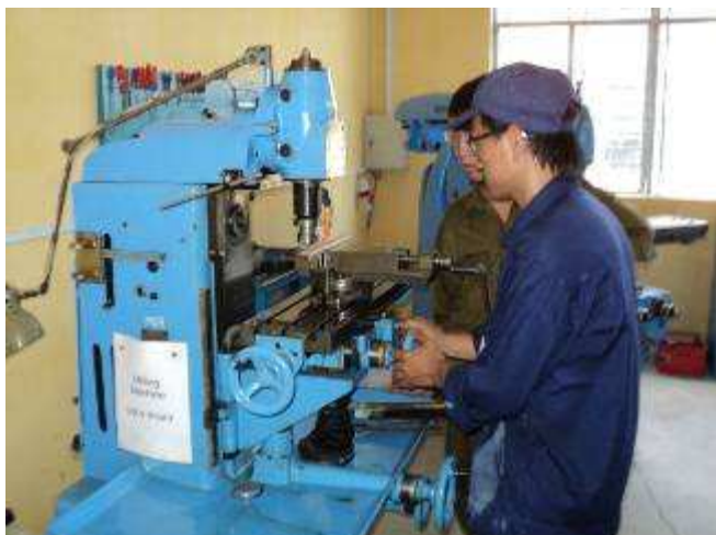
Photo 19: Als die Lehrlinge die Spindel laufen hatten, sagte ich „Stopp! Welcher Durchmesser hat der Fräser? Wie rechnet man die Drehzahl aus? Wo waren da die Lehrer? Die Spindel lief ca 5 x zu schnell. So rechnet man es aus: Fräser Durchmesser x 3,14 gibt Umfang. Bei HSS 24 Meter = 24000mm / Umfang = Drehzahl. 100 x muss man das sagen bis es sitzt, damit man mit geschlossenen Augen weiss, wie es geht.
