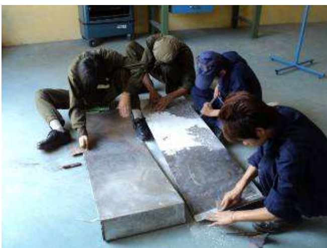
Photo 15: An den Blechen werden von Hand die 2 Komponentenfarbe entfernt. Ist eine Fleissarbeit.
