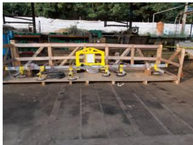
P58: Vacum Heber. Que foi nomeado para a máquina de jato de água, porque há uma grande quantidade de material inoxidável.
