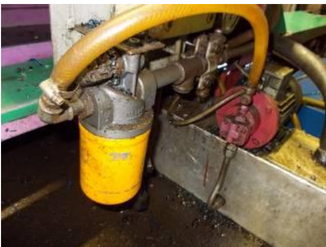
P13: No Gornati: Com todas as máquinas CNC da WiAP, tem 10 micron filtro. Do lado de fora com um interruptor de sinal, de modo que a sujeira no óleo pode ser interceptado. Cada engrenagem da máquina com os filtros, pode depois de 10 anos de tampa da caixa de velocidades ser levantada. Ele não tem quaisquer vestígios de sujidade.
