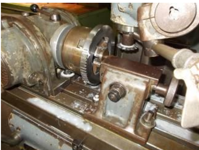
P38: o grande engrenagem é re-estabelecida. Infelizmente, com o módulo de moinhos de 2,5, em vez dos dois cortadores módulo. Aqui nós temos a engrenagem
