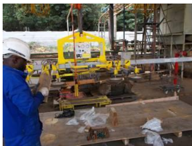
P59: Ele deve levantar placas até 50 mm de espessura e 2600 x 1300 milímetros
