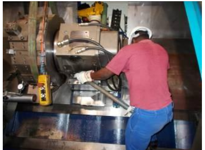
P15: A torreta do mega Bore estava inclinado a 100 mm de curso de 1 mm. Então, novamente, um grande acidente.
