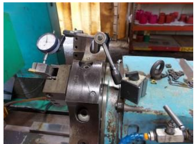
P26: A torre deve estar sem folga, caso contrário ele irá vibrar durante a rotação. Isto significa que os requisitos de qualidade não forem cumpridas.
