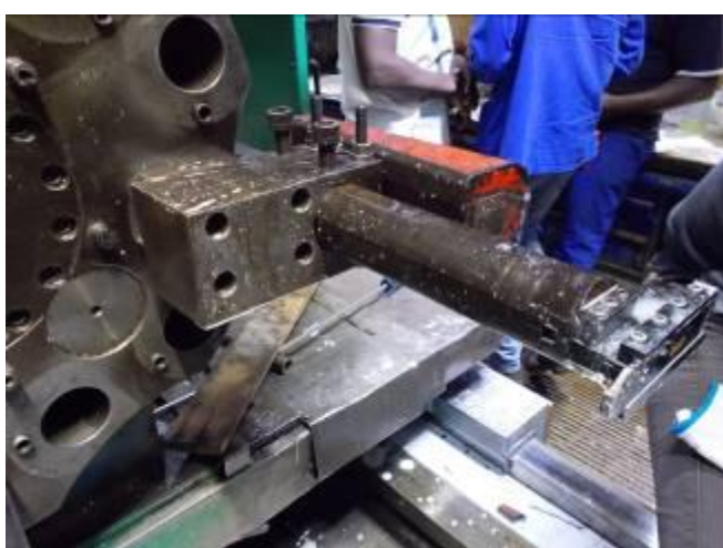
P70: fazer um Innedrehstahl de uma ferramenta de viragem exterior, foi complicado porque a geometria tiveram de ser adaptados. Em outras palavras, um exterior de aço tem um ângulo de incidência diferente de um interior de aço.
