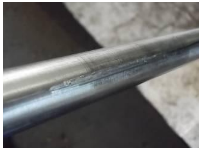
P4. Um eixo em que o garfo de mudança é executado, erodiu. Infelizmente, o material emparelhamento aço no aço foi escolhido. Dá apenas uma fricção de 0,01 com óleo n. Mas não há buracos de lubrificação. Portanto, há um risco para comer. Se bronze ou PTFE bucha lá, ele também não iria secar pode mastigar.
