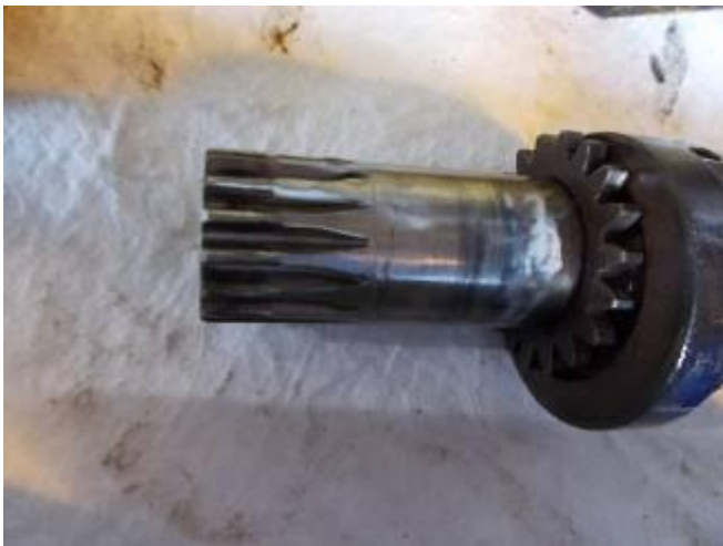
P36: A roda com defeito na engrenagem de alimentação
