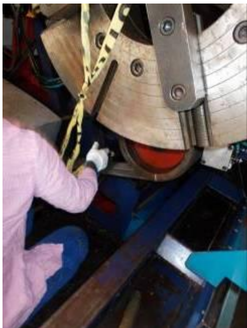
P17: retire o cabeçote é muito difícil. Estes parafusos M24 classe 12.9 deve ser apertado e solta em um metro por 94 kg. Isso leva muita força.
