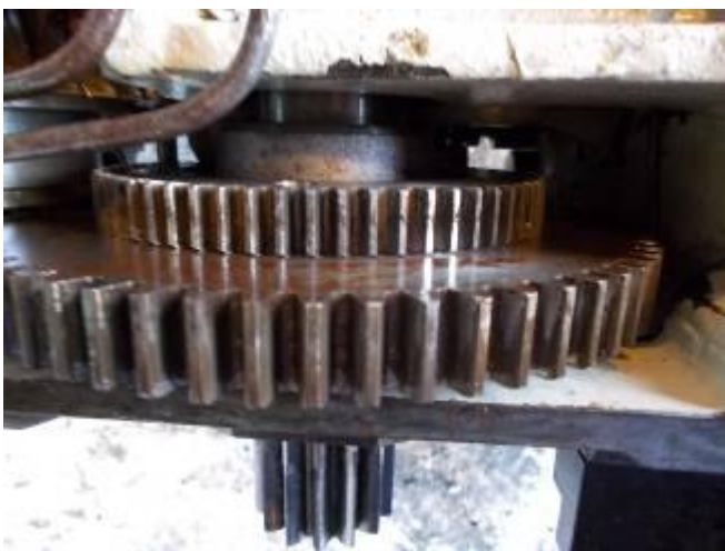
P37: A roda defeituosa, menor, mais dentes estão quebrados. Foi soldado e reparado. Infelizmente não é bom o suficiente. O módulo de idade, foi escolhido errado, porque a quebra de qualquer coisa tão deformado que não pôde ser determinado corretamente. Quando o equipamento foi usado com o chefe de divisão, dentes utilidades domésticas uma vez com muito pouco, em seguida, novamente com uma distância muito grande.
