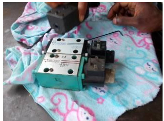
P29: A máquina não se move. A válvula foi substituída. Esse não foi o problema.
