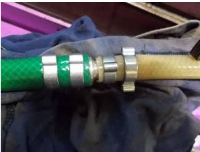
P23: A embreagem nova rodada e anexados braçadeiras duplas de mangueira
